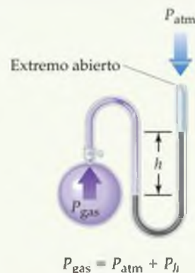
▲ Figura 10.3 Manómetro de mercurio. Este dispositivo en ocasiones se utiliza en el laboratorio para medir las presiones de gases cercanas a la presión atmosférica.
